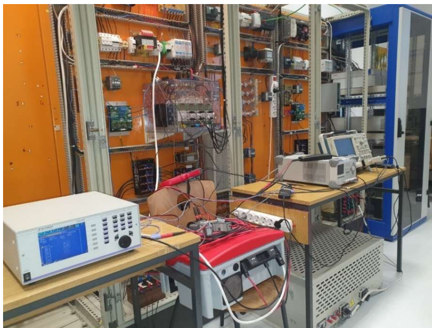
Slika 7.1. Laboratorijska postavka za snimanje harmonijskog spektra struje PV invertora.
